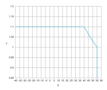
X : Operating temperature (°C)Y : AC coil voltage (UC)
