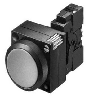
22MM PLASTIC ROUND COMPLETE UNIT COMBINATION: PUSHBUTTON WITH FLAT BUTTON SCREW TERMINAL, 1NO WITH HOLDER BLUE
