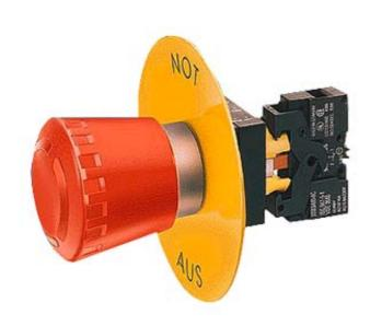
22MM PLASTIC ROUND COMPLETE UNIT COMBINATION: PUSH-PULL BUTTON 40MM LATCHING W.PULL-TO-UNLOCK MECH. SCREW TERMINAL, 1NO+1NC WITH HOLDER RED
